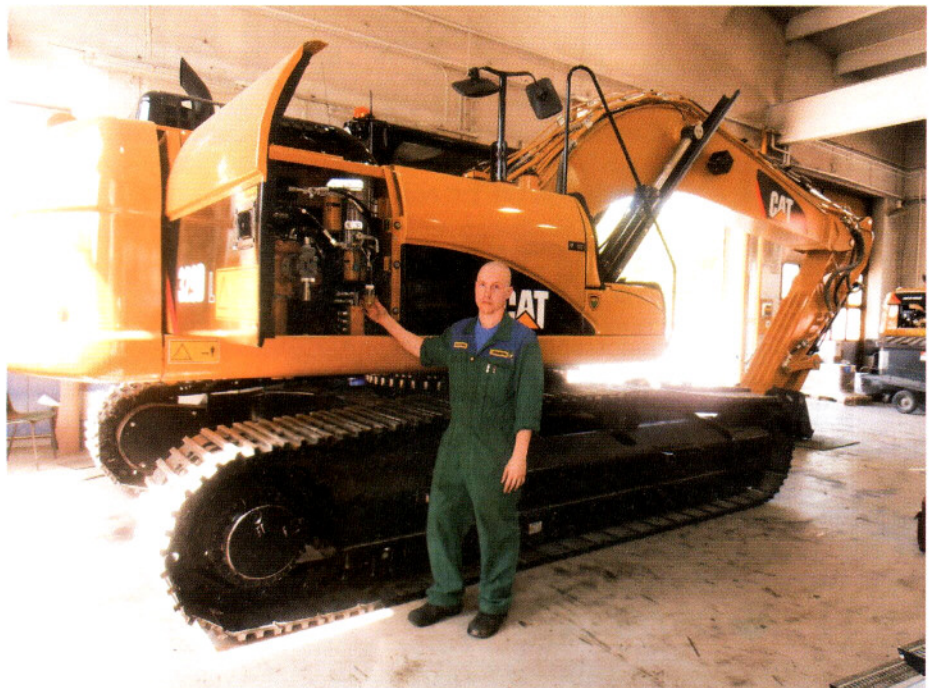
KUVA 1. Säännöllinen öljynäytetutkimus on olennainen osa koneiden käynninvarmistusta. Vantaan Caterpillar-huollon mekaanikko Kalle Korhonen ottamassa näytettä.
