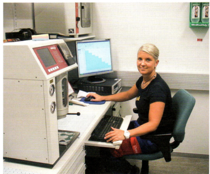
KUVA 6. Laboratoriohiukkaslaskimella mitataan paperi- ja sellutehtaan sekä voimalaitoksen öljynäytteet Stora Enso Oyj:n tehtaalla Imatralla. Efora Oy:n kunnossapitoasentaja Maijaelina Ovaska tarkastaa hiukkaslaskentatuloksia.
